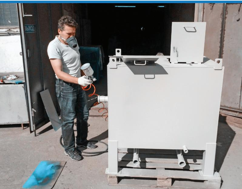
*Покраска основного очистного модуля установки «Экора» — сепаратора производительностью до 4 м<sup>3</sup> жидкости в час, предназначенного для разделения несмешиваемых жидкостей типа «вода — нефть», «вода — масло» и т. п. На фото инженер ООО «Экологические разработки» Петр Макаров.*
