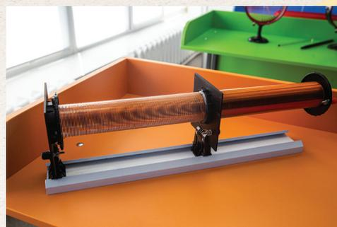
Соленоид — однослойная цилиндрическая катушка для создания однородного магнитного поля
