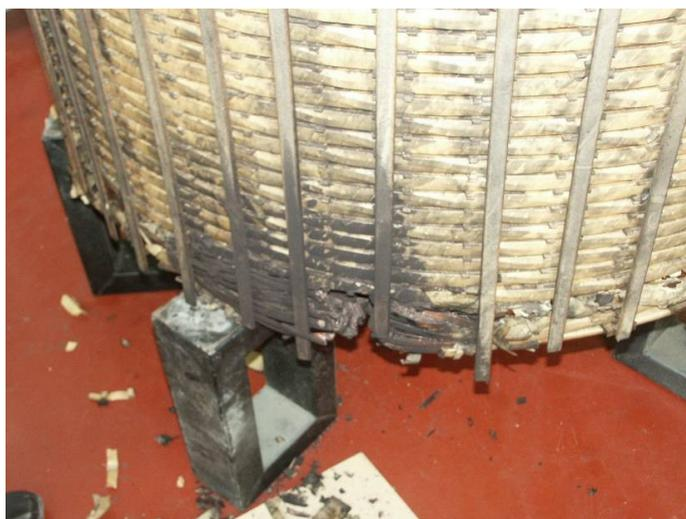
Рисунок 15 – Витковое замыкание в обмотке автотрансформатора
