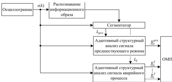
Рисунок 23 – Блок-схема процессора обработки электрического сигнала ОМП в составе ССПТИ (показан только один канал)
