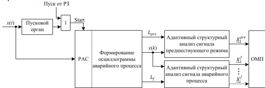
Рисунок 21 – Блок-схема процессора обработки электрического сигнала в автономном ОМП (показан только один канал)
