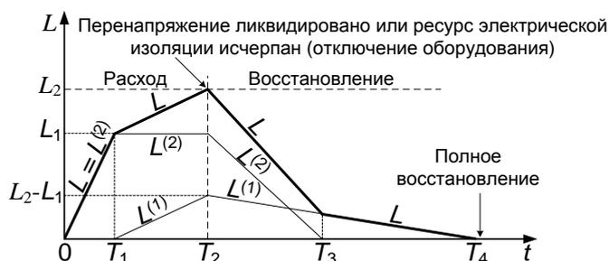
Рис. 10. Процессы учета восстановления ресурса электрической изоляции при изменении уровня перенапряжения в предлагаемом способе
