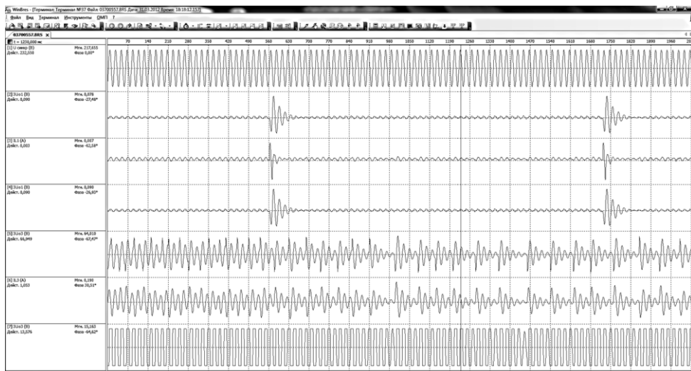
Рисунок 12 – Осциллограмма процесса измерения параметров в 1-й секции и режима ОЗЗ во 2-й секции
