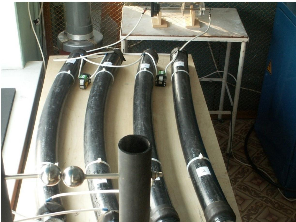
Рисунок 3.4 – Экспериментальный ГИН с шаровыми разрядниками
