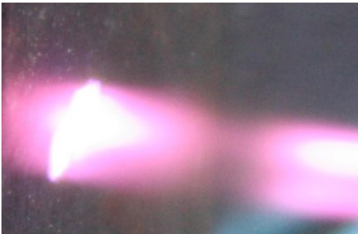
Рисунок 2.35 – Фотография ионизируемой области на электроде «плоскость» с использованием монокристалла никеля в качестве электрода «плоскость»
