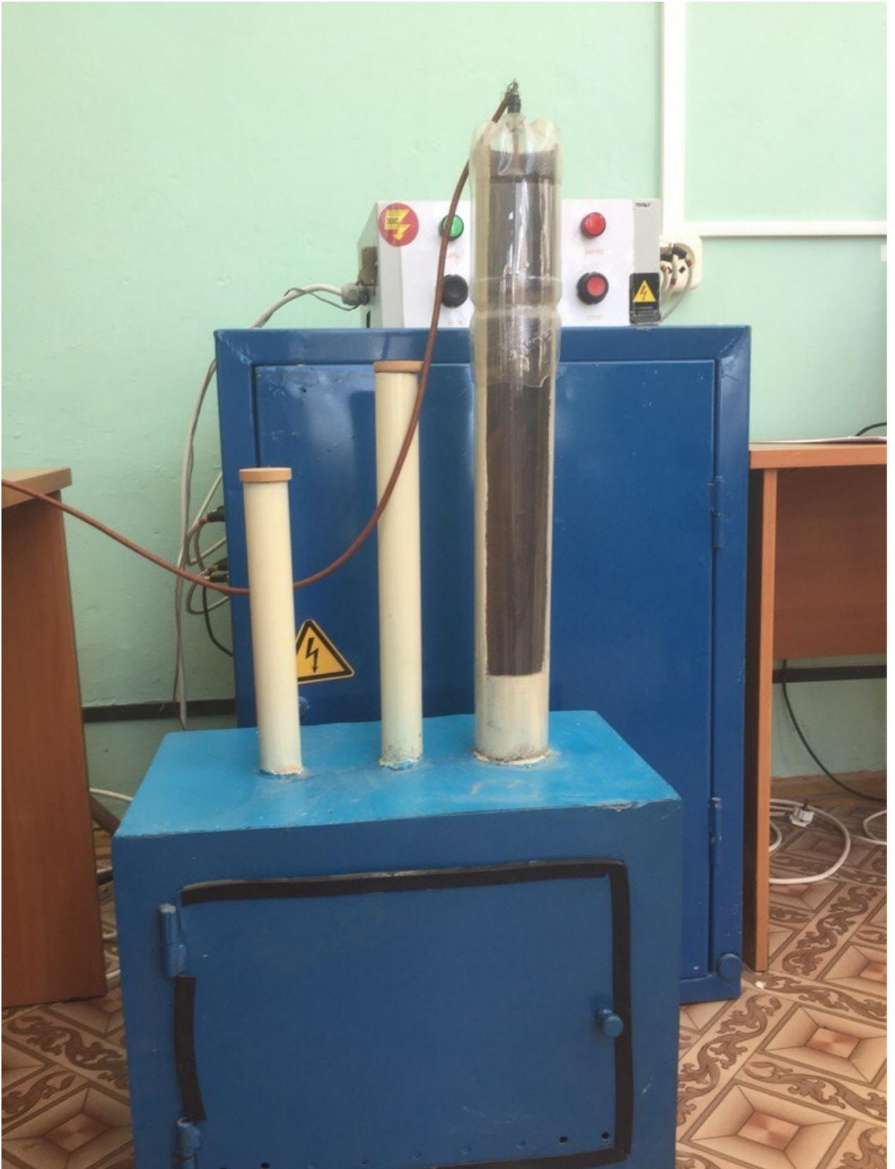
Рисунок 4.7 – Реакционная камера вертикального типа
