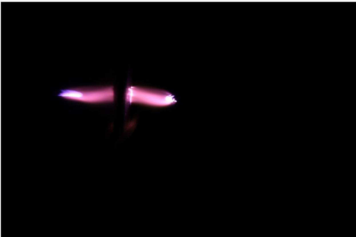
Рисунок 2.34 – Фотография ионизируемой области реакционной камеры с использованием монокристалла никеля в качестве электрода «плоскость»
