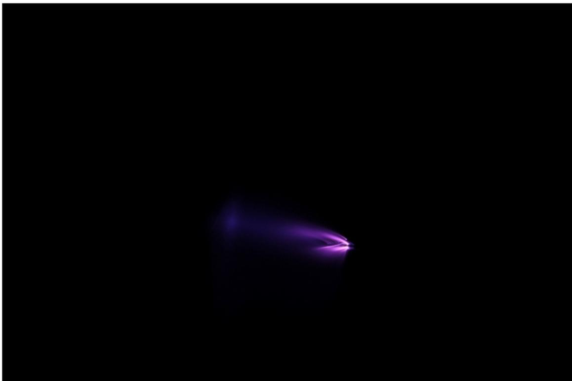
Рисунок 2.27 – Фотография ионизируемой области реакционной камеры с использованием поликристалла железа в качестве электрода «плоскость»
