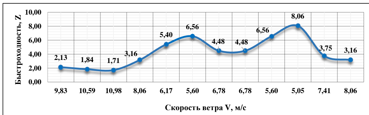
Рисунок 2.6 – Зависимость быстроходности от скорости ветра
