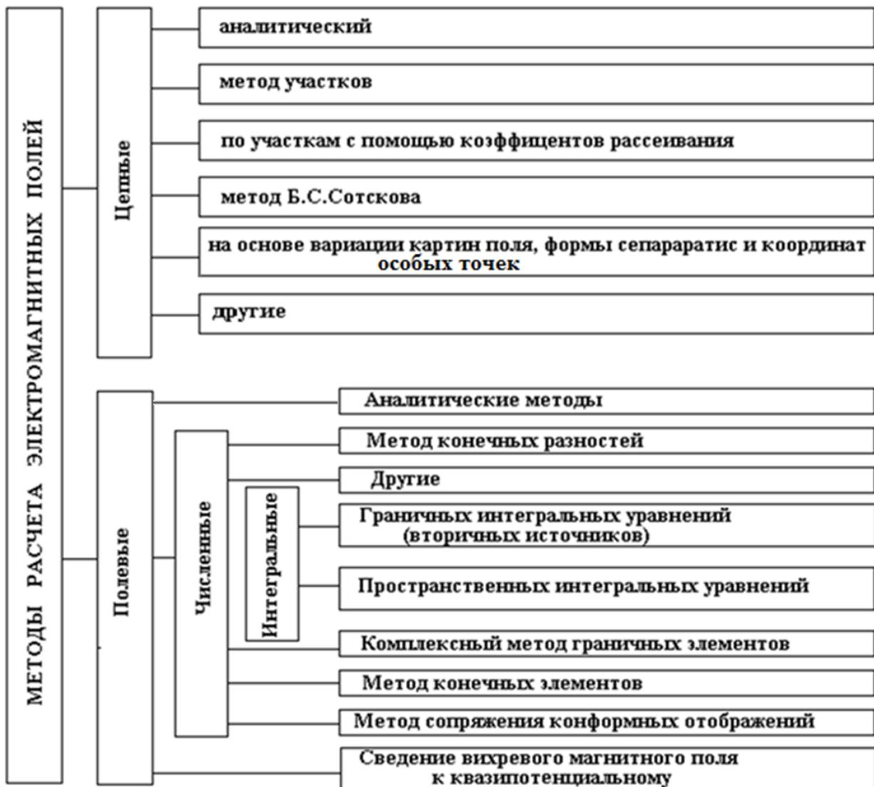
Рисунок 1.4 - Методы расчета электромагнитных полей
