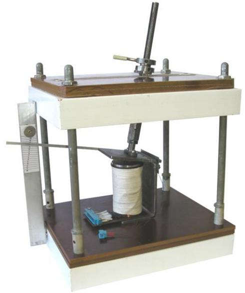
Рисунок 1.8 - Платформа для установки магнитных систем
