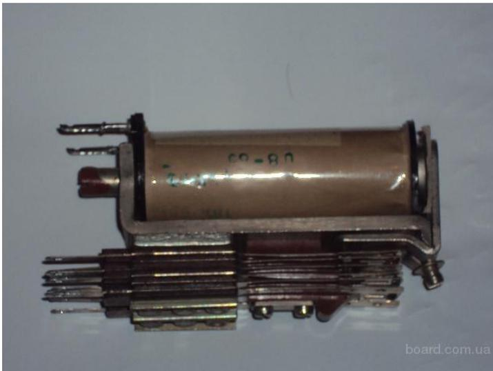
Рис. 3.4 - Реле типа РКН.
