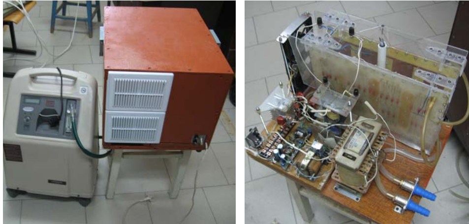
Рисунок П. Б. 1 – Фотографии опытного образца озонаторной установки с разрядными камерами с высоковольтными электродами и электронно коммутируемым источником питания.
