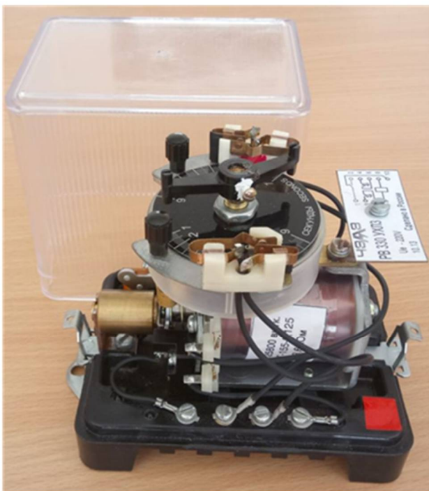
Рисунок 3.4 – Внешний и общий виды разработанного электромеханического реле времени с часовым механизмом
