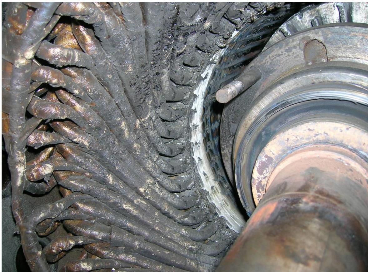
Рисунок 1.1 – Разрушение витковой и корпусной изоляции статора ВАЭ
