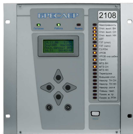
Рис. 9 Терминал защиты трансформаторов «Бреслер ТТ 2108»
