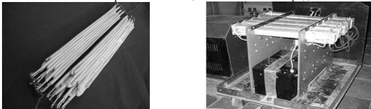
Рисунок 15 – Кассета и внешний вид озонаторной установки с проволочными электродами
