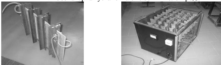
Рисунок 16 – Кассета и внешний вид озонаторной установки с плоскими электродами
