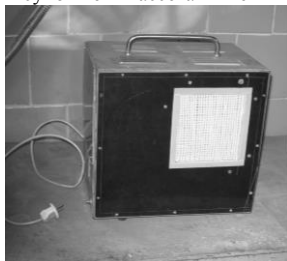
Рисунок 17.–Озонаторная установка открытого типа
