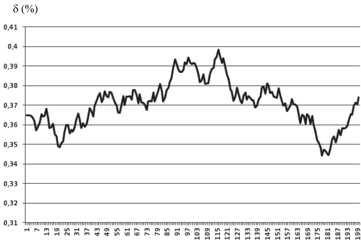
Рис. 4.7. Погрешность вычислений \delta (%) (—) значения эквивалентного сопротивления R_3 при числе реализаций, равном 200, при n = 10
