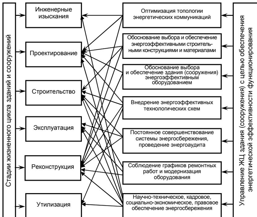
Рис. 3. Структура реализации энергосберегающих мероприятий в процессе управления жизненным циклом зданий и сооружений
