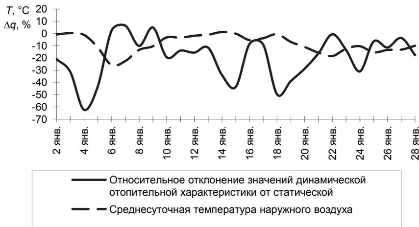
Рис. 4. Изменение в течение января 2015 г. среднесуточной температуры наружного воздуха и относительного отклонения значений динамической отопительной характеристики от статической
