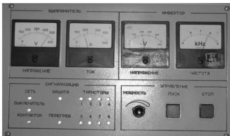
Рис. 10. Приборный блок комплекса с одновитковым индуктором для закалки шеек валов
