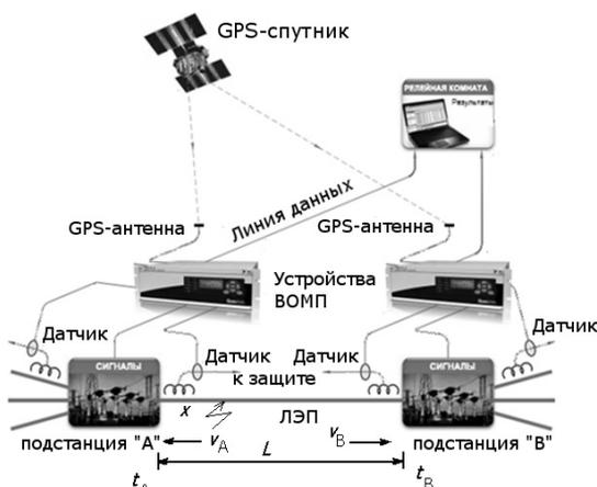
Рис. 1. Схема подключения ВОМП на примере Qualitrol TWS FL-8
