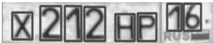
Рис. 3. Результат сегментации символов автомобильного номера
