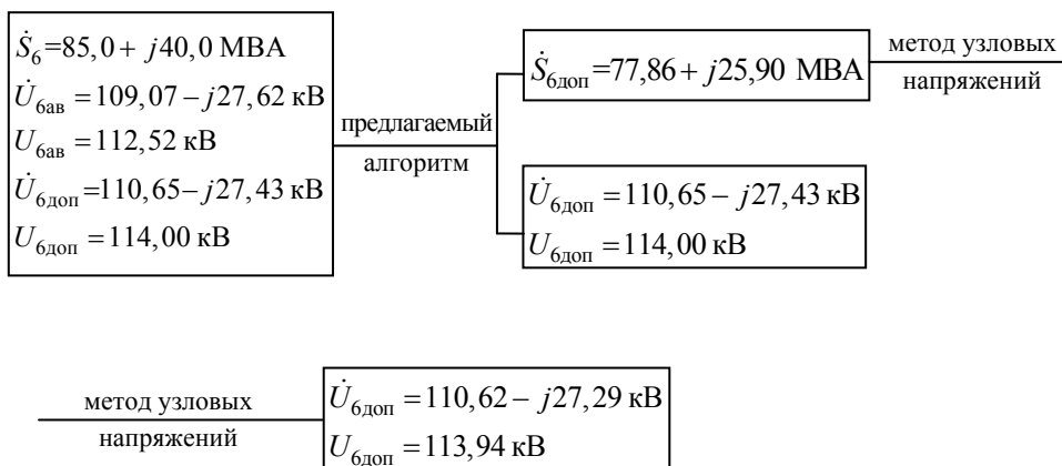
Рис. 2. Погрешность замены послеаварийных токов аварийными при расчёте необходимого ограничения нагрузки 6-го узла
