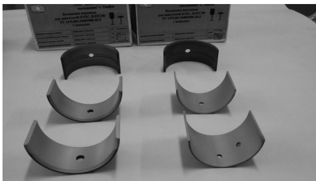
Рис. 2. Представители комплекта верхних и нижних коренных (левый ряд) и шатунных (правый ряд) вкладышей подшипников коленчатого вала дизельного двигателя
