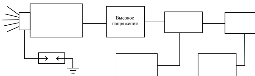
Рис. 7. Блок-схема управляемого активного молниеотвода
