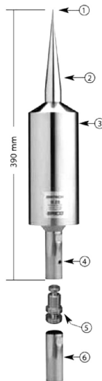
Рис. 2. Конструкция активного молниеприемника «Forend»: 1 – наконечник; 2 – корпус из нержавеющей стали; 3 – формирующий блок; 4 – крепежный винт; 5 – резьбовое соединение с мачтой; 6 – мачта
