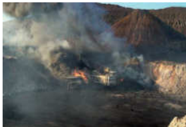
Рис. 4.7. Пример горения борта породно-угольного отвала
