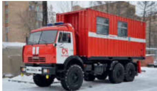
Рис. 2.13. Автомобиль пожарно-спасательного контейнерного типа АПСК (43118)
