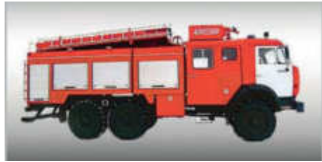
Рис. 2.12. Автомобиль насосно-рукавный ПАБР-2,0–20/200 (КАМАЗ-43118)
