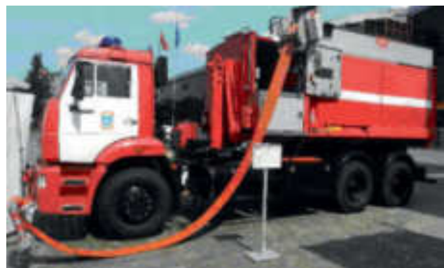
Рис. 2.15. Пожарный насосно-рукавный комплекс «Поток»
